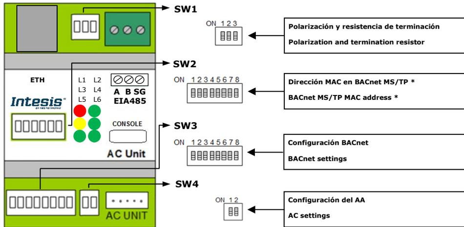
SW1 – Polarización y terminación – Polarization and termination
