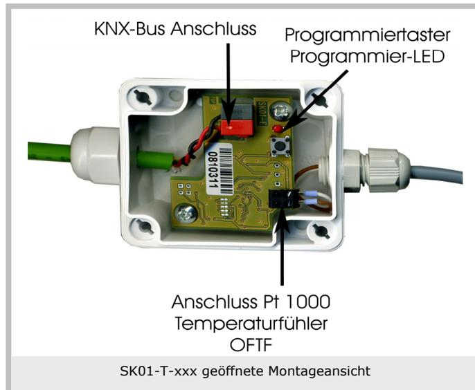
Der Deckel des Messumformers wird durch Drehen der Befestigungsschrauben um 90° gelöst.
