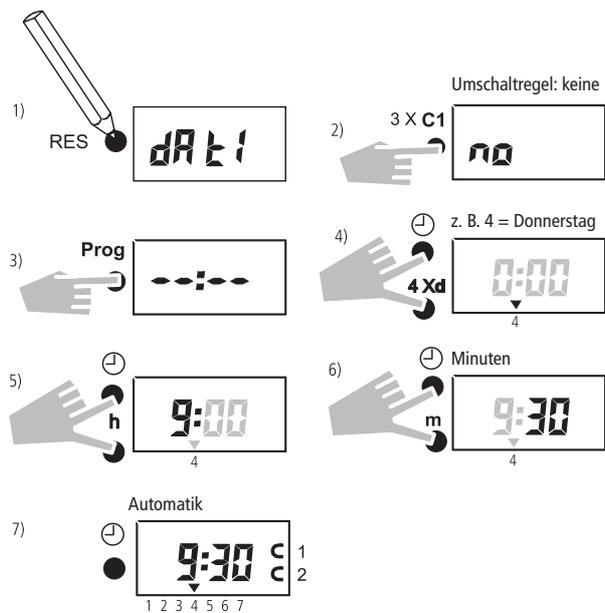
Wird die Taste
