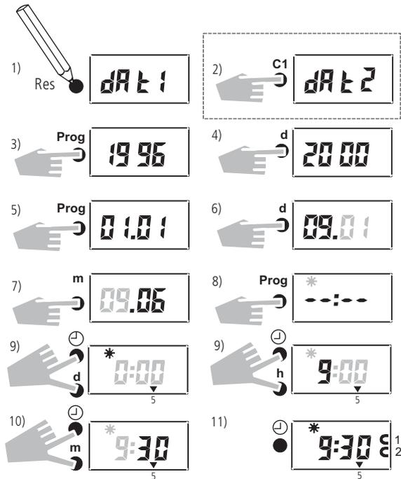
Wird die Taste  $\ominus$  nach der Uhrzeiteingabe losgelassen, müssen die beiden Punkte zwischen der Stunden- und Minutenanzeige blinken.
