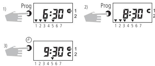
**Bild 1:** Einschaltung (C) im Kanal C1 erfolgt Mo, Di, Mi, Fr 6:30 Uhr.
