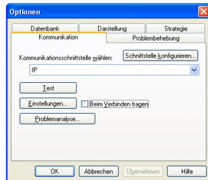
Nach Anklicken der Schaltfläche *Schnittstelle konfigurieren...* öffnet sich der ETS Connection Manager.
