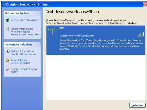
Da das KNX IP Interface 740 wireless einen DHCP-Server integriert hat, sollte die IP Adresse des PCs automatisch (DHCP) eingestellt werden. Bei den meisten Laptops ist dies die Standardeinstellung.
