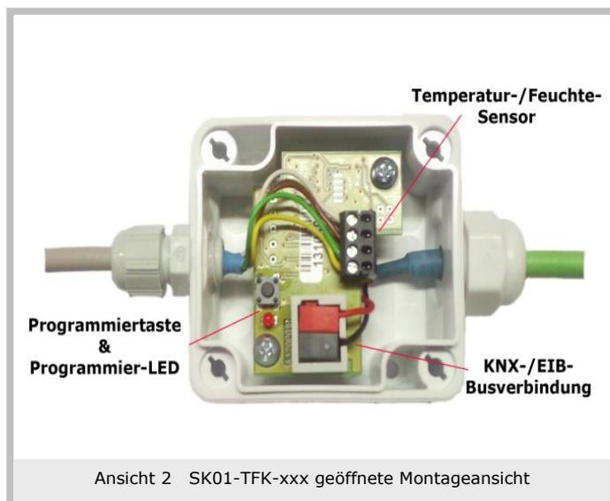
Der Deckel wird durch Drehen der Befestigungsschrauben um 90° gelöst.
