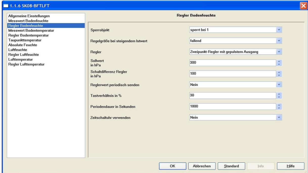
**Regelgröße bei steigendem Istwert: fallend/steigend** Der Regelsinn des Reglers kann an die Charakteristik der Regelstrecke angepasst werden.
