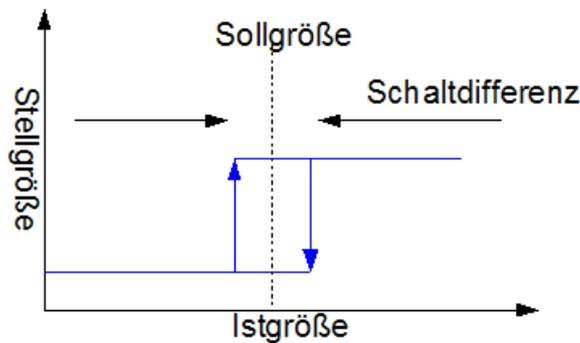
**Zweipunktregelung mit gepulstem Ausgang:**
