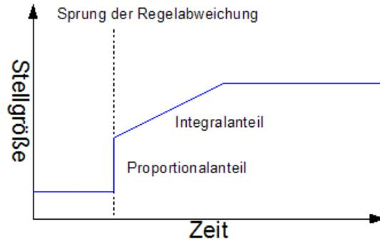
**Stetige PI-Regelung mit gepulstem Ausgang (PWM):**
